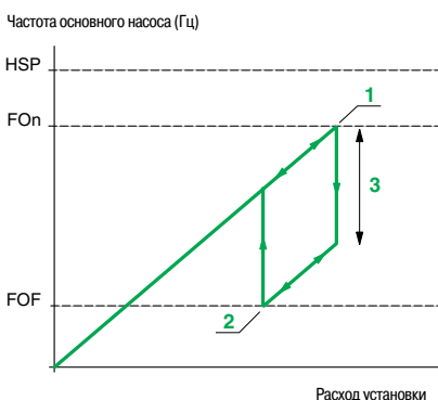
Работа основного и вспомогательного насосов: гистерезис
